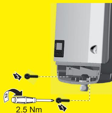
Falownik uruchamiać wyłącznie po dobrym dokręceniu go śrubami mocującymi!
